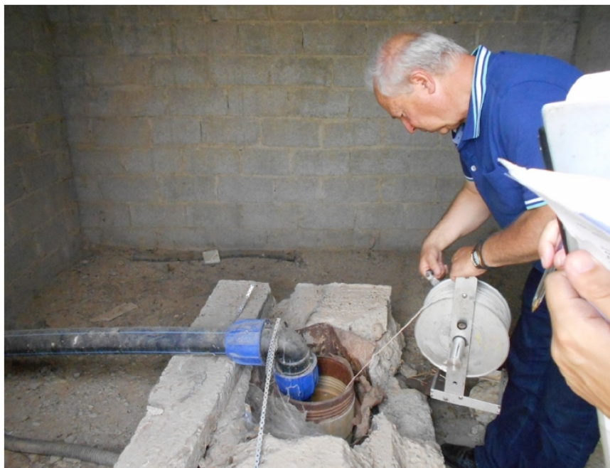
Σχήμα 10. Υδραυλικό πιεζόμετρο τοποθετείται εντός αρδευτικής γεώτρησης για την μέτρηση της στάθμης υπόγειου ύδατος, από τη Διεύθυνση Υδάτων Θεσσαλίας. Θέση γέφυρας Τεμπών, στον Πηνειό ποταμό. [αρχείο: Αντώνιος Βασιλόπουλος]
