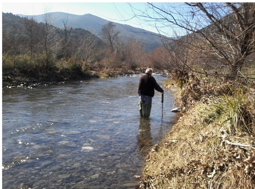
Σχήμα 7. Θέση μέτρησης της ταχύτητας υδατορεύματος (και εκτίμησης της παροχής του) από τη Διεύθυνση Υδάτων Θεσσαλίας. Θέση «Κέδρος» στον Σοφαδίτη ποταμό. [αρχείο: Αντώνιος Βασιλόπουλος, Άννα Σαλμά]
