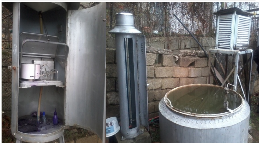
Σχήμα 5. Σταθμός της Διεύθυνσης Υδάτων Θεσσαλίας στην τοποθεσία «Μεγάλη Κερασιά» Καλαμπάκας. Περιλαμβάνει (από αριστερά): βροχόμετρο, βροχογράφο, κλωβό θερμομέτρων, εξατμισίμετρο (κάτω). [αρχείο: Άννα Σαλμά]
