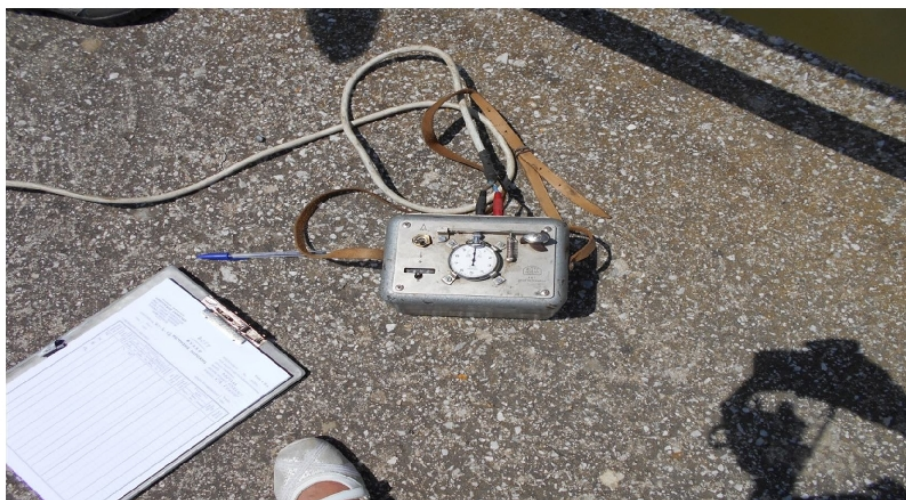
Σχήμα 9. Καταγραφικό όργανο για τη μέτρηση της ταχύτητας υδατορεύματος και την εκτίμηση της παροχής του, από τη Διεύθυνση Υδάτων Θεσσαλίας. Θέση γέφυρας Τεμπών, στον Πηνειό ποταμό. [αρχείο: Άννα Σαλμά]
